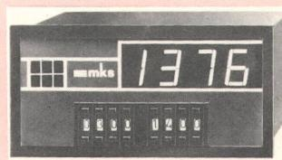
In der Ausführung DIL sind 16 Befehle möglich, die jederzeit geändert und neuen Anforderungen angepasst werden können. Die Ausführung PROM verfügt über einen Befehlsvorrat von 1024 Befehlen (Programmierung im Werk) und kann auch komplexe Zusammenhänge einschliesslich logarithmischer und trigonometrischer Funktionen auswerten. (Digitrade AG, 2501 Biel)
