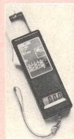
Weitere positive Punkte: grosser Frequenzbereich von 20 bis 500 Hz, geeignet für Rundleiter bis 30 mm Durchmesser und Flachleiter bis 50×30 mm, Stromversorgung durch handelsübliche 9-V-Batterie für rund 100 h Betrieb (Zustandsanzeige), Tragetasche und Kabelfest (3 Messleitungen) im Lieferumfang enthalten. Prüfspannung 2 kV.
