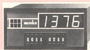
In der Ausführung DIL sind 16 Befehle möglich, die jederzeit geändert und neuen Anforderungen angepasst werden können. Die Ausführung PROM verfügt über einen Befehlsvorrat von 1024 Befehlen (Programmierung im Werk) und kann auch komplexe Zusammenhänge einschliesslich logarithmischer und trigonometrischer Funktionen auswerten. (Digitrade AG, 2501 Biel)
