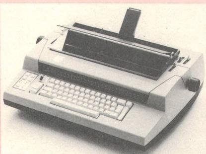
IBM Schweiz, 8002 Zürich, hat zwei neue elektronische Schreibmaschinen angekündigt: die IBM 85 und IBM 65. Beide Modelle vereinigen eine ansehnliche Reihe von modernsten Leistungsmerkmalen auf sich. Nur die wichtigsten seien stichwortartig aufgeführt: 3fache Schrittschaltung (10 und 12 Pitch, Proportionalschrift), 21 Korrespondenzschriften, automatischer Randausgleich (Blocksatz), geräuscharm, Schweizer Normtastatur (96 Zeichen), Zeilenspeicher (223
