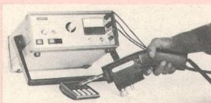
**Avantages:** capacité de choc et résistance de décharge à sélectionner lors de la commande (exécution standard  $C_s = 150 \text{ pF}$ ,  $R_d = 150 \Omega$  selon CEI); possibilités d'opération: mode tension continue et nombre de chocs présélectionnés; shunt in-
