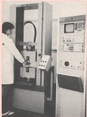
Der Materialprüfcomputer verfügt über eine werkstoff- und versuchsspezifische Software zur Steuerung und Kontrolle des Versuchsablaufs sowie zur Erfassung der Messwerte und der daraus resultierenden Versuchsergebnisse und Werkstoffkennwerte. Neben den üblichen Werkstoffkennwerten können Elastizitäts-, Schub- und Gleitmodul ebenso ermittelt werden wie die unterschiedlichsten Dehnmasse und das Arbeitsvermögen der Proben bei einem vorwählbaren Beanspruchungszustand.
