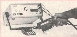
Avantages: capacité de choc et résistance de décharge à sélectionner lors de la commande (exécution standard  $C_s = 150 \text{ pF}$ ,  $R_d = 150 \Omega$  selon CEI); possibilités d'opération: mode tension continue et nombre de chocs présélectionnés; shunt in-
