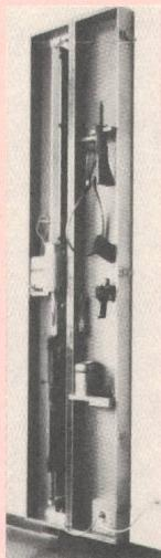
Der Magclean führt in einem vorprogrammierten Reinigungsprozess innerhalb etwa 2 min rund 100 Bewegungen im Gewehrlauf aus, wobei die Kupferbürste sowohl vorne als auch hinten vollständig aus dem Lauf ausgefahren wird, wie es im Reglement vorgeschrieben wird.
