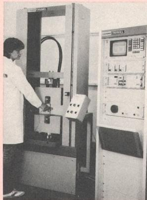
Der Materialprüfrechner verfügt über eine werkstoff- und versuchsspezifische Software zur Steuerung und Kontrolle des Versuchsablaufs sowie zur Erfassung der Messwerte und der daraus resultierenden Versuchsergebnisse und Werkstoffkennwerte. Neben den üblichen Werkstoffkennwerten können Elastizitäts-, Schub- und Gleitmodul ebenso ermittelt werden wie die unterschiedlichsten Dehnmasse und das Arbeitsvermögen der Proben bei einem vorwählbaren Beanspruchungszustand.
