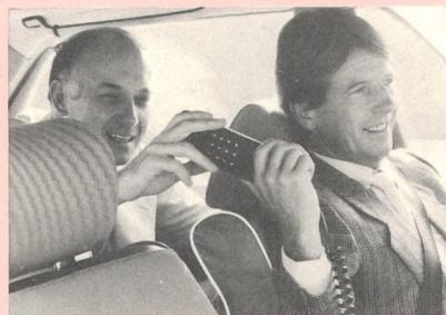
Kompakte Bauweise, Speicher mit hundert Telefonnummern, helligkeitsgesteuerte Nummernanzeige, Repetierautomatik und elektronische Nummernsperre sind die hervorstechendsten Merkmale des jüngsten Sprosses der Familie der Natel-Geräte von BBC Brown Boveri, 5401 Baden, dem Natelstar. Durch den Einsatz modernster Elektronik konnten bei diesem Autotelefon alle Bedienelemente im Hörer untergebracht werden. Das bisher nötige Bediengerät fällt somit weg.
