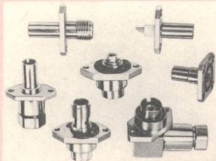
Koaxialsteckerfamilie unter der Bezeichnung PMMA für die blinde, unverriegelte HF-Verbindung für Einschubsysteme entwickelt. Der in einer Spiralfeder schwimmend gelagerte Steckerkörper gleicht auch grössere Fluchtungstoleranzen beim Einführen aus. Die Flanschgehäuse sind aus einem Stück Edelstahl gefertigt und deshalb trotz ihrer Kleinheit sehr robust. Die Innenleiter sind vergoldet, und die Gehäuse können sowohl passiviert als auch vergoldet geliefert werden.
