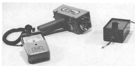
Fig. 5 Appareils de mesure du champ électrique De gauche à droite: sonde radioactive, moulin à champ (Feldmühle), champmètre électronique
