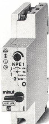
Treppenlichtautomat mit Digitalelektronik, Baureihe KPE. 100% Einschaltdauer, 50 mA Ruhestrom, für Dreie- und/oder Vierdräht-Steigleitungen. Zeitbereiche von 10 s bis 70 min, Dreistellungs-handschalter, schmales Normgehäuse von nur 17,5 mm Breite. Einsatz als Zeitrelais.
