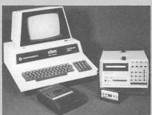
Die Kombination Kassettenregistriergerät Combilog und CBM-Tischrechner ermöglicht, die verschiedensten Messdaten zu erfassen, zu speichern und anschliessend die Resultate rasch und gezielt auszuwerten.
