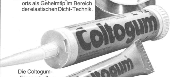
Die Coltogum-Eigenschaften: pastöse, standfeste Konsistenz, dämpft Erschütterungen (stossdämpfend), haftet auf praktisch allen Werkstoffen, alterungs- und witterungsbeständig, wasserabweisend. Temperaturfestigkeit: +200° bis -60°. Isolationswiderstand über  $1 \times 10^{14}$  Ohm x cm.
