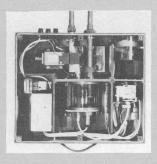
stellbaren Probenvolumina. Eine komplette Messeinrichtung besteht aus dem Wasserprobenentnahme-Gerät ASP 9260, dem Gefäss zur Aufnahme der Proben, den Schlauchleitungen und – bei durchflussabhängiger Probenentnahme – einer Schaltung, die in durchflussproportionaler Häufigkeit die Probenentnahme veranlasst.
