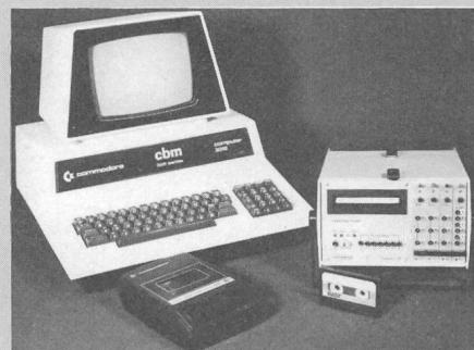
Die Kombination Kassettenregistrator Combilog und CBM-Tischrechner ermöglicht, die verschiedenen Messdaten zu erfassen, zu speichern und anschliessend die Resultate rasch und gezielt auszuwerten.
