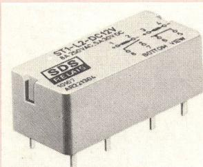
Ausserdem ist das ST-Relais C-Schaltungs-kompatibel, d. h. dass es auch bei monostabilem Schaltverhalten während der Einschaltzeit nur die vernachlässigbare Betriebsleistung von etwa 2 mW benötigt. Da der Kontaktwiderstand unter 10 mΩ liegt, ist auch die Erwärmung gering. Das ST-Relais ist gasdicht verkapstelt, VDE-, SEV- und UL-gerecht.
