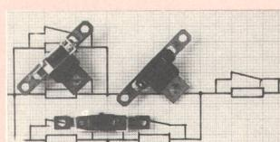
Logische Verknüpfungen sind sehr einfach. Will man mehrere Stellen eines Geräts oder einer Anlage überwachen und abschalten, wenn an einer die Temperatur überschritten ist, so braucht man die Schalter nur hintereinander zu schalten. Soll erst abgeschaltet werden, wenn an mehreren Punkten der Grenzwert überschritten ist, so verdrahtet man die selbsthaltenden Thermoschalter parallel. Natürlich sind auch Kombinationen aus Reihen- und Parallelschaltungen möglich.
