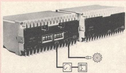
geräte arbeiten nach dem Periodendauermessprinzip mit anschliessender Kehrwertbildung (Rechnerprinzip). Die Anzahl der bei einer Messung berücksichtigten Perioden ist abhängig von der Höhe der Eingangsfrequenz und vom Messbereichswert. Sie liegt zwischen  $10 \cdot f$  für den niedrigsten und  $0,01 \cdot f$  für den höchsten Bereich (0...1 Hz bzw. 0...99,99 kHz).
