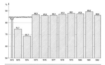
Fig. 2 Verfügbarkeit des Kernkraftwerkes Mühleberg
