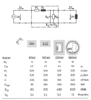
Fig. 2 Typische elektrische Werte für Kabelleitungen (hohe Übertragungsleistung)
