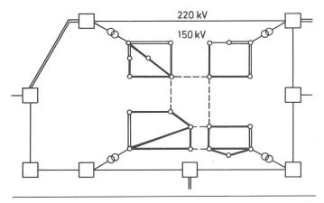
Fig. 7b 150-kV-Netz aufgetrennt
