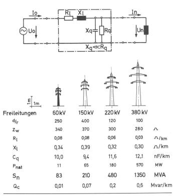
Fig. 1 Typische elektrische Werte für Freileitungen
