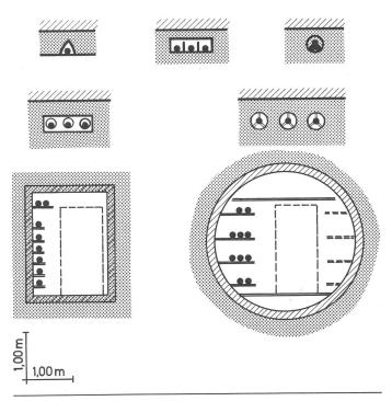
Fig. 6 Kabelverlegungsarten (Beispiele)
