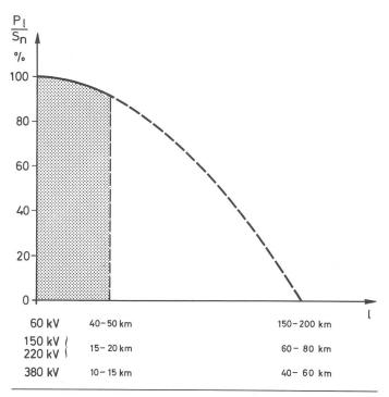
Fig. 3 Kabel-Transportleistung in Funktion der Leitungslänge
