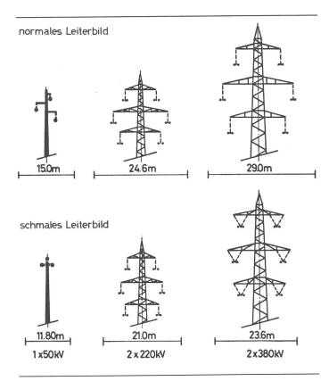
Fig. 5 Trassebreiten von Freileitungen
