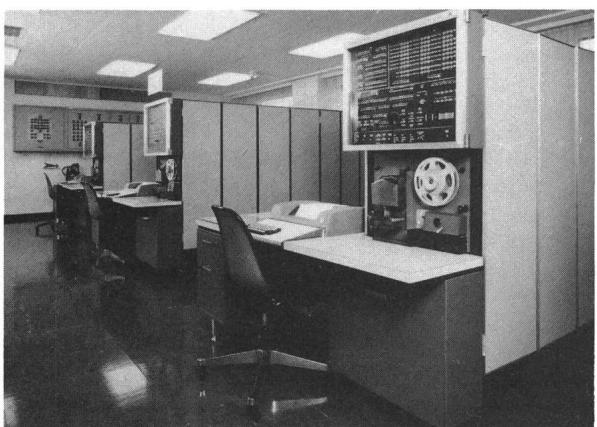
und leitet sie selbständig über Landleitungen, Seekabel oder Satellitenverbindungen in die Schweiz, nach Europa oder Übersee weiter. Der Telegrampkunde wird dank ATECO schneller bedient und der Arbeitsablauf entscheidend vereinfacht. Das System verarbeitet 6000 Telegramme pro Stunde und leistet damit seinen Beitrag zur schnellen weltweiten Kommunikation.
