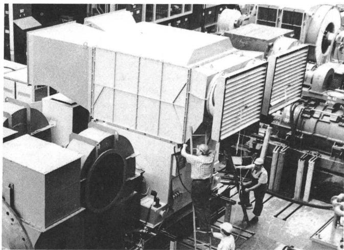
Höhe der 3-MW-Drehstromgenerator, der eigentliche Stromerzeuger, untergebracht sein, den das Bild zusammen mit dem aufgebauten Kühler im Prüffeld zeigt. Die elektrische Anlage umfasst neben dem Generator einen Umrichter und den dazugehörigen Schaltanlagen eine umfassende Leittechnik, zu der auch die Steuer- und Regeleinrichtungen zur automatischen Verstellung der beiden je 50 m langen Rotorblätter und zur Nachführung der Maschinengondel je nach Windrichtung gehören, wobei 324 t zu bewegen sind.
