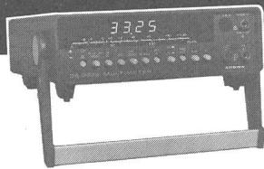
DA-3232 True-rms-Multimeter mit 3000 Digit LED und Leuchtbild-Anzeige Messbereiche bis 2 kV 20 A, Akku/Netz
