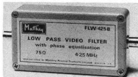
Die Serie besitzt alle früheren attraktiven Merkmale: flacher Durchlassbereich, scharfe Begrenzung, guter Phasenausgleich usw. Dazu kommt jedoch, dass im Sperrbereich bis 100 MHz die Dämpfung grösser als 45 dB ist. Außerdem wurde das Volumen um 70% verringert.
