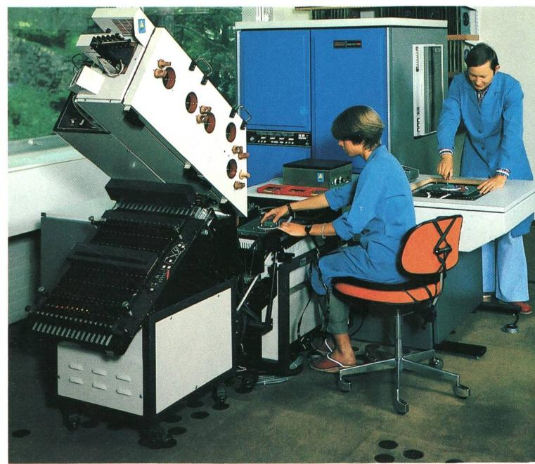
– Elektrische Prüfung von LSI- und VLSI-ICs auf SENTRY VIII-Prüfanlage: 60 und 120 Pins
