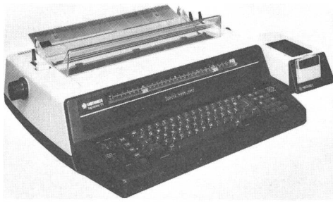
Fig. 3 Machine à écrire électronique à disque d'impression avec mémoire additionnelle sur micro-disque magnétique (à droite), de fabrication récente
