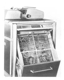
Fig. 7 Externe Schalttafelsteuerung
