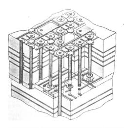
Fig. 10 Aufbau eines Logik-Chips mit etwa 400 bis 450 Schaltkreisen
