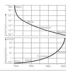
Fig. 9 Entwicklung der Packungsdichten und Schaltzeiten von Rechenelementen
