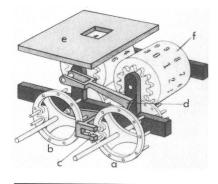
Fig. 2 Zählräder und Zehnerübertrag von Pascal a Einerrad; b Zehnerrad; c Klaue; d Sperrklinke;
