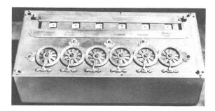
Fig. 1 Rechenmaschine von Blaise Pascal
