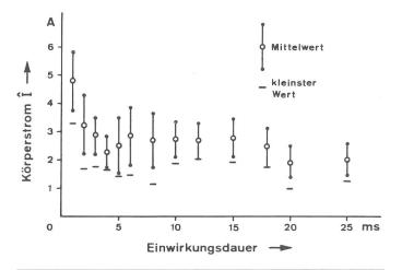
Fig. 1 Flimmerstromstärken I(Scheitelwerte) für Wechselstromimpulse von 1 ms bis 25 ms nach Green [9].
