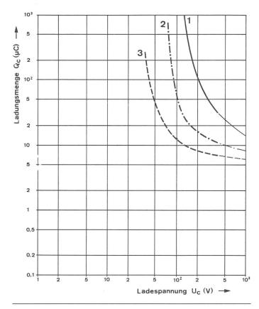
Fig. 11 Schmerzschwelle bei Kondensatorentladungen nach O. Stauss
