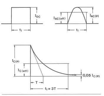
Fig. 7 Bezeichnung der charakteristischen Stromwerte für Rechteckimpulse, sinusförmige Halbwellenimpulse und Kondensatorentladungen.
