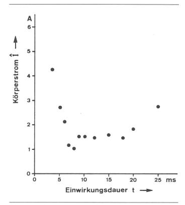
Fig. 4 Flimmerstromstärken I (Scheitelwerte) für Wechselstromimpulse von 1 ms bis 25 ms nach Green [9].
