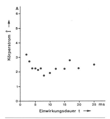
Fig. 3 Flimmerstromstärken I (Scheitelwerte) für Wechselstromimpulse von 1 ms bis 25 ms nach Green [9].
