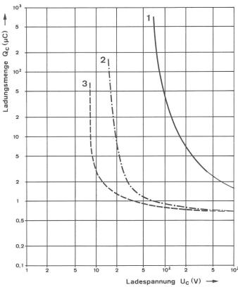
Fig. 9 Wahrnehmbarkeitsschwelle bei Kondensatorentladungen nach O. Stauss
