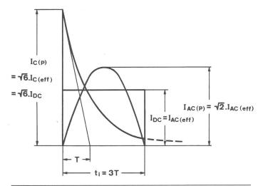
Fig. 8 Vergleich eines Rechteckimpulses, eines sinusförmigen Halbwellenimpulses und einer Kondensatorentladung mit gleicher Impulsdauer  $t_{\rm i}$  und gleicher spezifischer Flimmerenergie  $F_{\rm e}$
