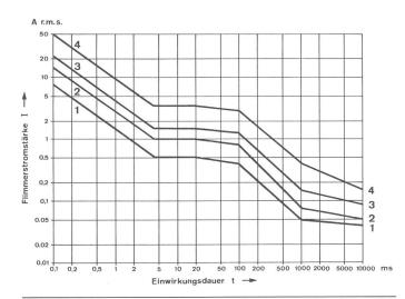
Fig. 6 Normungsvorschlag für den Menschen einschl. Kinder: Flimmerschwellen für 5%, 50% und 95% Wahrscheinlichkeit für Herzkammerflimmern und IEC-Sicherheitsschwelle S für Einwirkungsdauern von 0,1 s bis 10 s.
