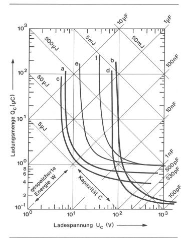
Fig. 10 Wahrnehmbarkeitsschwelle bei Kondensatorentladungen über den menschlichen Körper
