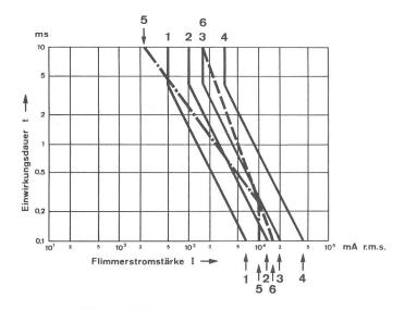
Fig. 12 Flimmerschwellen für 5%, 50% und 95% Wahrscheinlichkeit für Herzkammerflimmern und IEC-Sicherheitsschwelle S für Einwirkungsdauern von 0,1 ms bis 10 ms.
