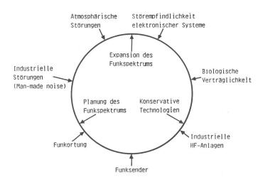
Fig. 2 Faktoren, welche die Kapazität des Frequenzspektrums bestimmen
