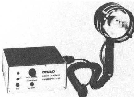
Regelmäßige Bewegungsabläufe scheinen stillzustehen und erleichtern so die Beobachtung. Einfach montierbare Geber sowie handliche Blitzlampen machen Drelloskope zu einem optimalen Hilfsmittel.
