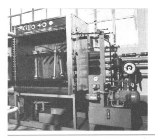
Fig. 3 Wechseldruckprüfung 5 bar/15 bar; 130 °C Links Prüflinge im Wärmeschrank
