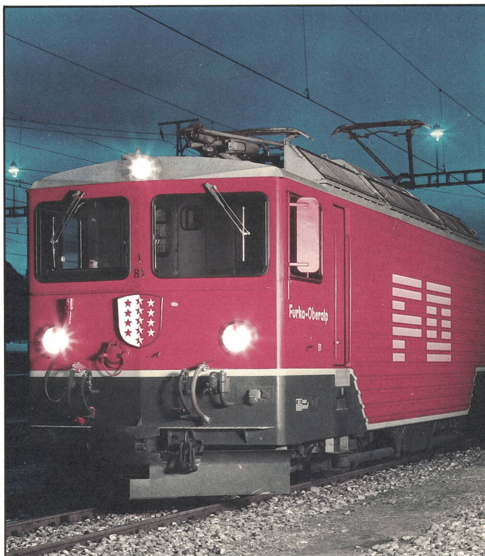
Lokomotive der Furka-Oberalp-Bahn Leistung 1700 kW
