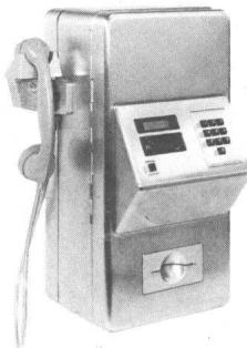
Alle diese Probleme bestehen beim bargeldlosen Automaten mit Wertkarte nicht. Diese Wertkarte hat die Grösse einer Kreditkarte und enthält die Werteinheiten in Form einer holografischen Mikrostruktur. Im Telefonautomaten werden die Werteinheiten durch den Leser mit einem einfachen Löschvorgang schrittweise vernichtet.
