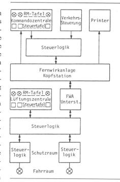
Fig. 4 Aufbau der Beleuchtungssteuerung FWA Unterst. Unterstation der Fernwirkanlage Übrige Bezeichnungen analog Fig. 2
