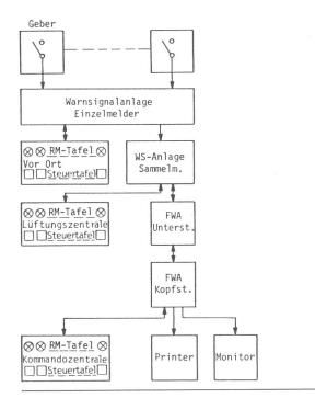
Fig. 5 Aufbau der Warnsignalanlage Sammelm. = Sammelmeldungen Übrige Bezeichnungen analog Fig. 2
