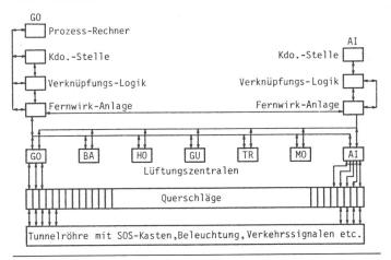
Aufbau der Steuerung und Überwachung
