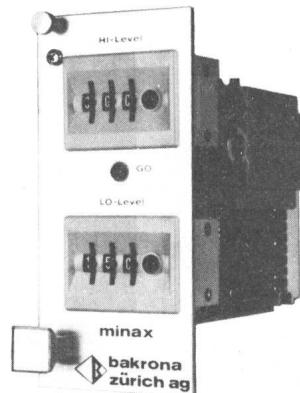
in einen Normmeinschub eingebaut werden. Im schützenden Gehäuse ist er als anschlussfertiges, praktisches und handliches Tischgerät benützbar. Dank dem DIN-Stahlblechgehäuse (magnetische Abschirmung) und der Netz-Entstörung eignet sich der «minax» auch für den Einbau in Schalttafeln.
