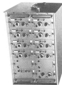
lenswert, wo mehrere Ladungsverstärker gleichzeitig verwendet werden. Die Kontrolleinheit wird daher standardmäßig z.B. in der Elektronikeinheit für 6-Komponenten-Kraftmessung Typ 9807 eingesetzt. Die Kontrolleinheit hat die gleichen äusseren Abmessungen wie die Universal-Ladungsverstärker Typ 5006/5007/5008/5009 und kann daher im gleichen Gehäuse oder Rackrahmen untergebracht werden.
