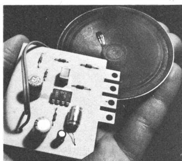
Bauelementen aus. Zusammen mit dem Lautsprecher ( $8\ldots15\ \Omega$ ) lässt sich die Gongschaltung in einem kompakten Gehäuse unterbringen, das kaum grösser als eine Zigarettenpackung ist. Der geringe Stromverbrauch von typ.  $1\ \mu\text{A}$  (in Bereitschaft) ermöglicht Batteriebetrieb über eine lange Zeit. Der Spannungsbereich geht von 7 bis 11 V.
