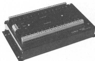
Trennung direkt an Klemmen anschliessbar; 1...7-k-Benutzerspeicher, ca. 4,5 ms Zykluszeit pro 1-k-Speicher; 128 Softwaretimer sowie 256 Merker; einfache Stromversorgung 9 VAC und 24 VADC; komfortable Programmierung mit nur 9 Befehlen, off- oder on-line, mittels preisgünstigem Entwicklungssystem und Bildschirmterminal.
