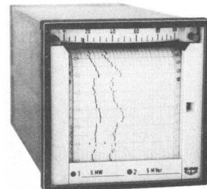
wird registriert und erscheint auf dem Diagramm als Treppenkurve. Der netsynchrone Antrieb des zeitkalibrierten Papiers erlaubt einen ausreichend genauen Vergleich der
