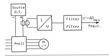
Fig. 20 Chaîne de mesure de vitesse par le biais du courant de source
