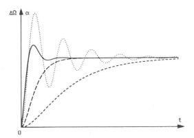
Fig. 6 Réponses d'un système du 2<sup>e</sup> ordre pour diverses valeurs des coefficients a et b de l'équation caractéristique
