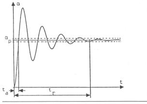
Fig. 1 Définition du temps d'avance  $t_a$  et du temps de réponse  $t_r$
