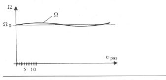
Fig. 2 Oscillations dynamiques de vitesse autour de la vitesse synchrone
