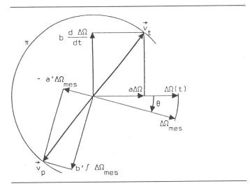
Fig. 10 Diagramme vectoriel décrivant l'effet des réglages théorique et pratique
