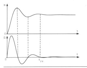
Fig. 12 Instant tro de déclenchement du régulateur
