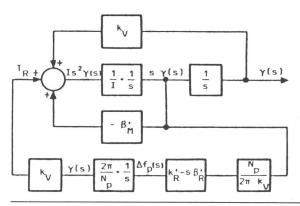
Fig. 9 Schéma fonctionnel d'un moteur pas à pas avec le régulateur de vitesse
