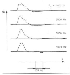
Fig. 19 Comportement du système asservi en vitesse par capteur, lors d'une perturbation
