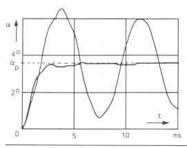
Fig. 13 Réponse en position lors de l'avance d'un pas, en boucle ouverte et avec régulateur
