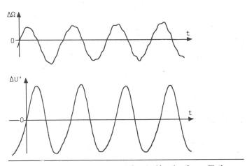
Fig. 21 Mise en évidence de la qualité de la détection des oscillations de vitesse par le courant ΔU' Signal à la sortie du filtre, fig. 20. f<sub>p</sub> = 1400 Hz
