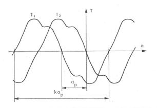
Fig. 7 Couple statique de deux phases adjacentes
