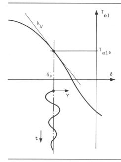
Fig. 5 Caractéristique angulaire d'un système synchrone
