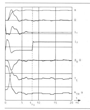
Fig. 14 Position  $\alpha$ , vitesse  $\Omega$ , courants  $i_1$  et  $i_2$  et couple  $\beta_{\mathbb{R}} \Omega$ ,  $k_{T\mathbb{R}} \alpha$ ,  $T_t$  lors de l'avance d'un pas ( $i \triangleq 1$  A/div)
