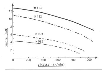
Fig. 2 Courbes caractéristiques de quatre moteurs différents
