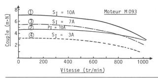
Fig. 1 Différentes caractéristiques d'un même moteur pas à pas selon le problème posé
