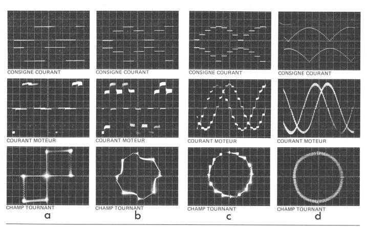
Fig. 7 Forme du champ tournant pour différentes commandes
