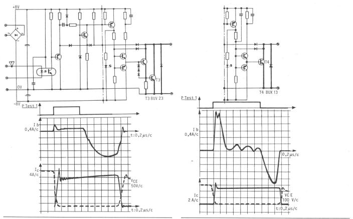
Fig. 5 Circuit de commande avec Darlington
