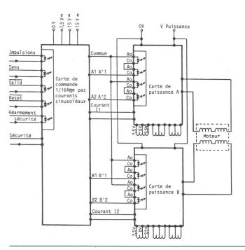
Fig. 10 Synoptique de l'ensemble de l'électronique de commande
