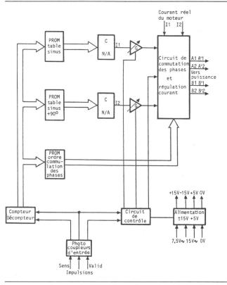
Fig. 9 Synoptique de commande 1/16 de pas
