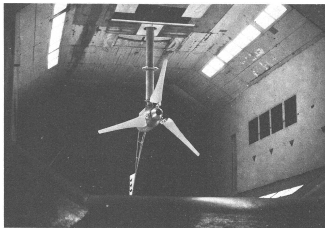
Fig. 1 Windenergiesystem im Windkanal des Eidg. Flugwerkes Emmen Rotordurchmesser 3,0 m
