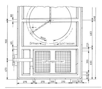
Fig. 6 Türe mit eingebautem zweiteiligem Lüftungsgitter
