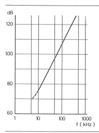
Fig. 8 Magnetische Felddämpfung des Türtyps Standard 2 in Funktion der Frequenz
