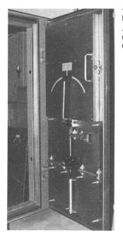
Fig. 3 Abdeckung des Antriebsmechanismus; obere Hälfte montiert, untere Hälfte demontiert
