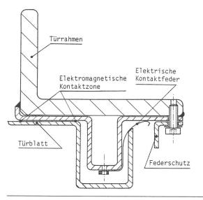
Fig. 2 Elektromagnetische Kontaktzonen
