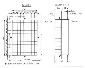
Fig. 7 Detail eines zweiteiligen Lüftungsgitters für 50 dB Dämpfung bei 10 kHz
