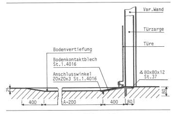
Fig. 5 Prinzip der schwellenlosen Türkonstruktion
