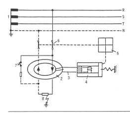
Fig. 3 Prinzip des herkömmlichen FI-Schalters
