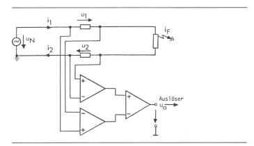
Fig. 22 FI-Schalterkonzept für Gleichfehlerströme (Prinzip des Summierens abgegriffener Spannungen an Widerständen)
