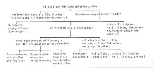
Fig. 27 Mögliche Entwicklungsrichtungen der FI-Schalter für Gleichfehlerströme
