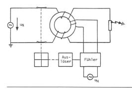
Fig. 19 FI-Schalterkonzept für Gleichfehlerströme (Prinzip des Fehlerwiderstandes)
