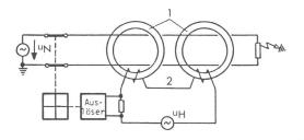
Fig. 26 FI-Schalterkonzept für Gleichfehlerströme (Transduktorprinzip)
