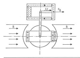
Fig. 24 FI-Schalterkonzept für Gleichfehlerströme (Prinzip des Summierens der Kräfte)
