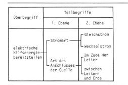
Fig. 13 Möglichkeiten der Bereitstellung der Messenergie
