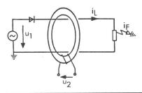
Fig. 6 FI-Schalter mit einweggleichgerichtetem Fehlerstrom
