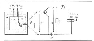
Fig. 25 FI-Schalterkonzept für Gleichfehlerströme (Prinzip des Hall-Effektes)
