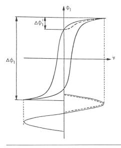
Fig. 4 Magnetisierung des Summenstromwandlers
