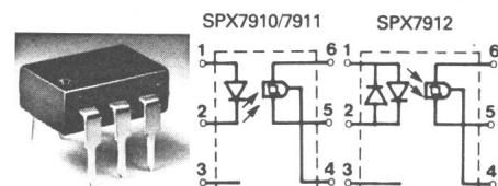
für direkte Ansteuerung von TTL- und CMOS-Gattern sowie den Anschluss von LED und kleinen Relais geeignet. Als Betriebsspannung benötigen sie 4,5...16 V. Der Ausgangsstrom beträgt max. 40 mA und die Schaltfrequenz max. 200 kHz.
