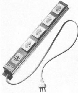
Problem. Die Einfügungsdämpfung des Filters wirkt zwischen 0,1 und 300 MHz. Das Filter dämpft sowohl symmetrische als auch asymmetrische Netzstörungen. Oft gelangen Netzstörungen auch über den Schutzleiter in die Geräte. Die eingegebene Drossel schaltet diese Erscheinung wirksam aus. Die Dosenleisten werden in zwei Größen angeboten: 4 Dosen, auch als 19"-Panel montierbar, oder 8 Dosen.
