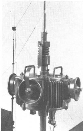
teten Strahlungscharakteristik, ein Anpassgerät binnen 1 s; während des Fahrbetriebs wird die verwendete Peitschenantenne vom selben Gerät angepasst. Durch die unsymmetrische Ausführung der Steilstrahlantenne verringert sich der Geländebedarf gegenüber herkömmlichen Steilstrahldipolen auf rund die Hälfte. (Roschi Telecommunication AG, 3000 Bern 31)
