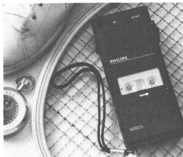
Gerät ist auch mit verschiedenem Zubehör erhältlich: Minicassette 2 x 15 min oder Minicassette 2 x 30 min, Konferenzmikrofon, Netzanschlussgerät, Telefonadapter sowie Reinigungscassette.
