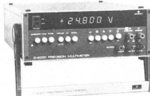
sind einige Punkte, die für die NORMA-Präzisions-Multimeter D-4025 und D-4045 (True-RMS-Ausführung) als Kalibrier- und Systemmultimeter sprechen. Mit eingebautem Bus-Interface können die Instrumente einzeln oder im Verbund mit anderen Geräten über den IEEE-488- oder IEC-625-Datenbus ferngesteuert oder in rechnergestützten Meßsystemen betrieben werden. Ohne Programmierung ist auch der Anschluss an den NORMA-Printer P-4995 zur numerischen Messwertausgabe möglich.
