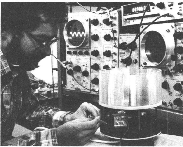
Fig. 4 Laboraufbau des Faserkreisels
