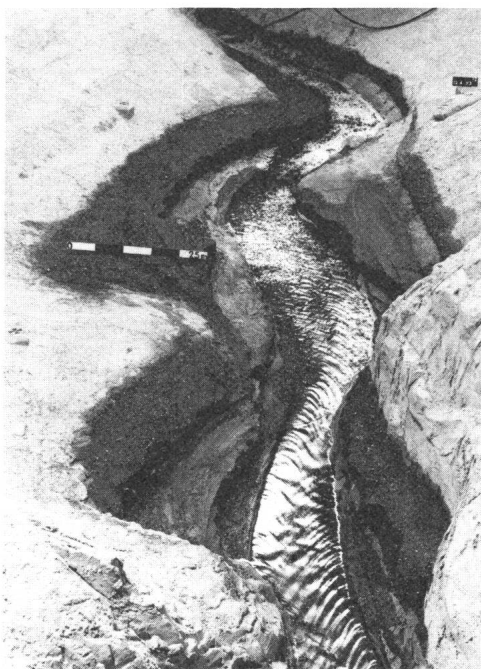
Fig. 2 Spülung eines stark verlandeten Stauraums im Modellversuch
