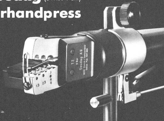
die pneumatische Presszange für lötfreie Kabelschuhe und Verbinder von 0,12 bis 6 mm<sup>2</sup>
