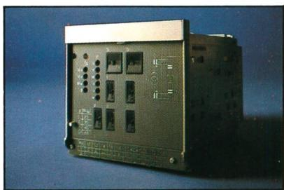
Das Differentialrelais DT92 für Transformatoren arbeitet ohne Zwischenwandler. Es ist an Schaltgruppe und Hauptwandlerübersetzungen direkt anpassbar. Die Einstellungen werden an der Frontplatte vorgenommen.
