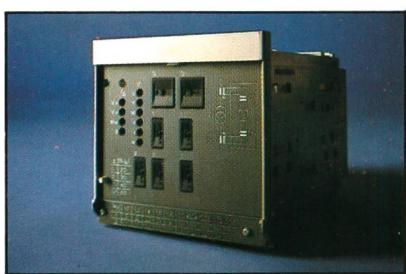
Das Differentialrelais DT92 für Transformatoren arbeitet ohne Zwischenwandler. Es ist an Schaltgruppe und Hauptwandler-übersetzungen direkt anpassbar. Die Einstellungen werden an der Frontplatte vorgenommen. Lassen Sie sich von uns beraten.
