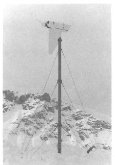
Fig. 2 Eolienne à hélice arrière
