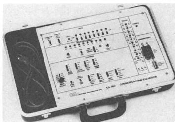
zwei RS 232C/V24 Interfaces und mit einer «Current Loop»-Schnittstelle ausgerüstet. Auf der Empfangsseite bietet ein 1-kByte RAM-Memory die Möglichkeit, einzelne Characters oder verschiedene lange Blöcke später abzurufen und zu vergleichen. Die Terminals, ob Bildschirm oder Drucker, können mit dem bekannten ASCII-Character-Set «The quick brown fox...» oder einem vom Kunden spezifizierten Testmuster angesteuert werden. Kurzfristig mögliche Lieferung ist ein weiterer Vorzug dieses Geräts.
