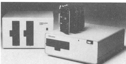
steht der allen Stationen zugängliche Massenspeicher mit einer Kapazität von 1...140 M-Byte (Floppy oder Hard-Disk). Unter Beibehaltung dieser Konfiguration können die Stationen jetzt mit einem lokalen Massenspeicher auf Halbleiterbasis ausgerüstet werden. Der neue Speicher wird als Peripheriegerät angesprochen mit einer Kapazität bis zu 512 KByte. Die Zugriffszeit ist etwa 1000-fach kürzer als bei einem mechanischen Speicher, zudem entfallen alle Verschleissprobleme.
