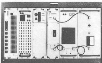
wellenfunkanlagen zur lückenlosen und ungestörten Funkversorgung grosser Gebiete, z.B. für Sicherheitsbehörden, Verkehrsbetriebe und Energieversorgungsunternehmen. Die Geräte sind für Ein- und Vielkanaltechnik ausgerüstet. Dank stabiler Sendeleistung, hochstabilem Oszillator, Modulator mit hoher Hubkonstanz, NF-Laufzeitausgleich, Leitungsentzerrer und automatischem Regelungsausgleich werden Interferenzstörungen und Modulationsverzerrungen vermieden.
