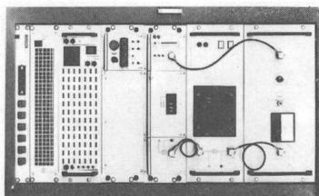
wellenfunkanlagen zur lückenlosen und ungestörten Funkversorgung grosser Gebiete, z.B. für Sicherheitsbehörden, Verkehrsbetriebe und Energieversorgungsunternehmen. Die Geräte sind für Ein- und Vielkanaltechnik ausgerüstet. Dank stabiler Sendeleistung, hochstabilem Oszillator, Modulator mit hoher Hubkonstanz, NF-Lauffzetausgleich, Leitungsentzerrer und automatischem Regelungsausgleich werden Interferenzstörungen und Modulationsverzerrungen vermieden.
