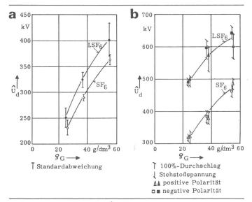
Fig. 1 Durchschlagspannung  $\hat{U}_d$  des gasförmigen  $SF_6(LSF_6)$  sowie des flüssigen  $SF_6(LSF_6)$  in Abhängigkeit von der Gasdichte  $\varrho_G$  bei Wechselspannungs- (a) bzw. Stoßspannungsbelastung (b)
