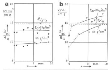
Fig. 4 Auf die Gasdichte bezogene Stoßdurchschlagfeldstärke Ê<sub>dG</sub>/Q<sub>G</sub> im Gasspalt des Schichtdielektrikums in Abhängigkeit von der Höhe s des LSF<sub>6</sub>-Pegels mit der Gasdichte Q<sub>G</sub> als Parameter Berechnet nach Gleichung (1) aus den in Fig. 3 dargestellten 50 %-Durchschlag-Stoßspannungen
