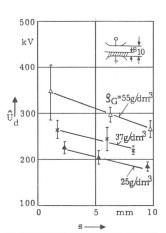
Fig. 2 Durchschlagwechselspannung  $\hat{U}_d$  des Schichtdielektrikums aus SF<sub>6</sub> und LSF<sub>6</sub> in Abhängigkeit von der Höhe s des LSF<sub>6</sub>-Pegels mit der Gasdichte  $\varrho_G$  als Parameter
