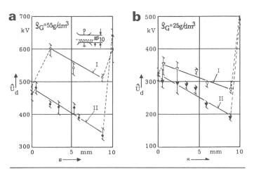
Fig. 3 Durchschlag-Stoßspannung  $\hat{U}_{\rm d}$  des SF<sub>6</sub> (s=0), des LSF<sub>6</sub> (s=10 mm) sowie des Schichtdielektrikums aus SF<sub>6</sub> und LSF<sub>6</sub> in Abhängigkeit von der Höhe s des LSF<sub>6</sub>-Pegels bei unterschiedlichen Gasdichten  $\varrho_{\rm G}$
