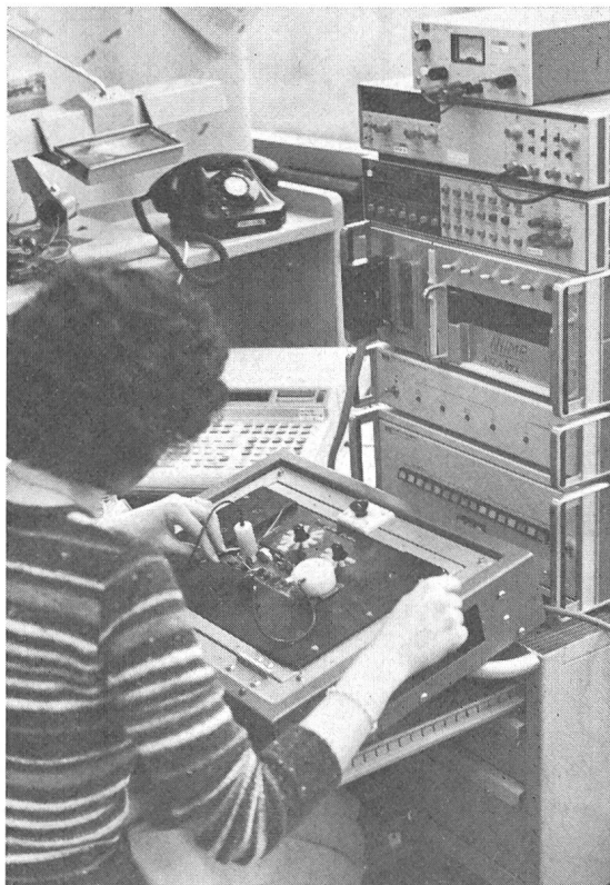
Fig. 5 Das ganze Prüfsystem Prüfling in Arbeitsstellung Tischrechner im Hintergrund
