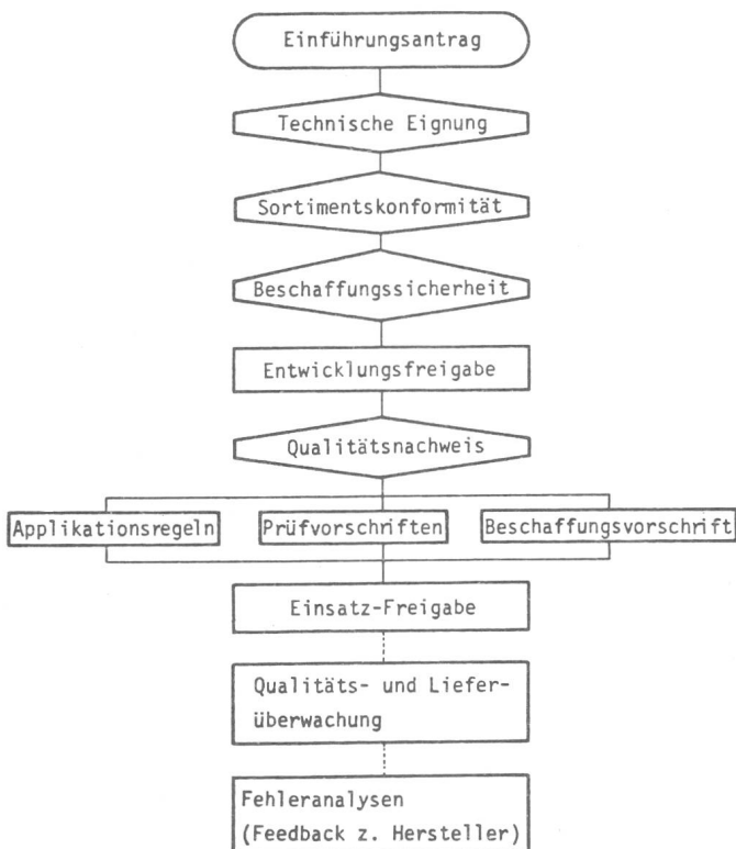
Fig. 1 Zeitlicher Ablauf der bauteileorientierten Massnahmen bei der Entwicklung und Herstellung elektronischer Geräte
