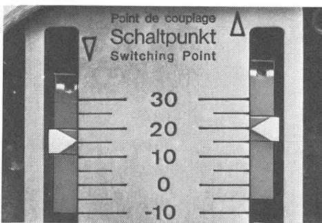
Ein vollständiges Produkteprogramm von Druck-, Differenzdruck- und Temperaturreglern. Schlagfest, spritzwassersicher und formschön. Geprüft durch die massgebenden europäischen Prüf- und Zulassungsbehörden (inkl. Schiffsbau). Geeichte Skalen mit hohem Auflösevermögen. Oberer und unterer Schaltpunkt sind unabhängig voneinander einstellbar. Korrosionsfeste, rüttelsichere, schwadensichere und explosionsgeschützte Geräte für hohe technische Ansprüche.
