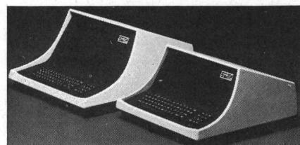
mit hoher Auflösung garantiert ermüdungsfreies Arbeiten. Die Übertragungsrate ist im Bereich 50...38400 Baud programmierbar.
