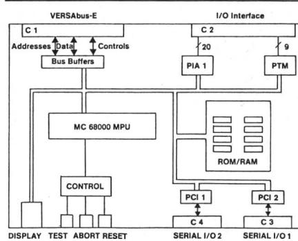
Taktfrequenz ist wählbar: 4, 8 oder 16 MHz. Der VME-16 hat einen Adressen-Umfang von 16 MByte. Er ist für Multiprozessor-Anwendungen und DMA geeignet.
