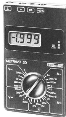
METRAVO<sup>®</sup> 2D: 25 Messbereiche bis 650 V $\approx$ , 20 A $\approx$ , 20 M $\Omega$ , 3 1/2-stellige LCD-Anzeige, Stromversorgung durch Batterie oder Netzadapter; 92x154x25 mm.
