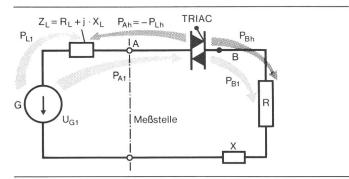
Fig. 2 Verlauf der Leistungsflüsse im Messkreis
