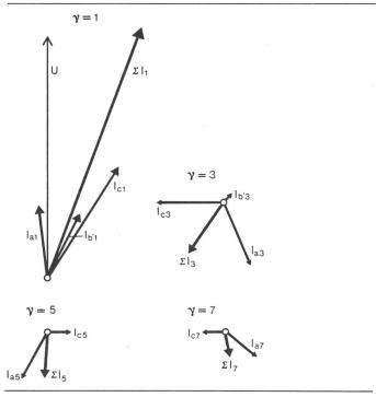
Fig. 12 Vektordiagramm der harmonischen Ströme Belastung (Index)
