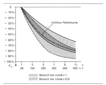
Fig. 7 Abhängigkeit der Messeigenschaften der Induktionszähler von der Netzfrequenz
