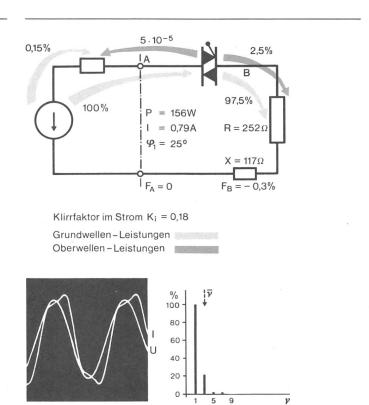
Fig. 10 Belastungsbeispiel Fluoreszenzbeleuchtung mit Kompensation
