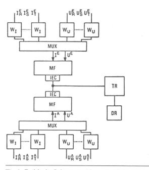
Fig. 6 Dreiphasige Leistungs- und Leistungsdifferenzmessung von Wechselgrössen für allgemeine Strom- und Spannungsverhältnisse mit Hilfe zweier Meßstellenumschalter (MUX)
