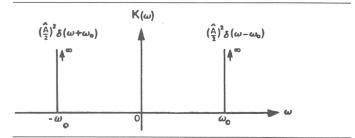
Fig. 1 Leistungsspektrum  $K(\omega)$  einer Sinusschwingung mit der Grundkreisfrequenz  $\omega_0$  und der Amplitude A
