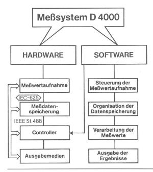
Fig. 8 Prinzip einer automatischen Messeinrichtung mit IEC-Bus-Steuerung für die Messung von Leistungskenngrössen
