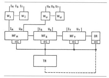
Fig. 4 Dreiphasige Leistungsmessung von Wechselgrössen bei allgemeinen Strom- und Spannungsverhältnissen
