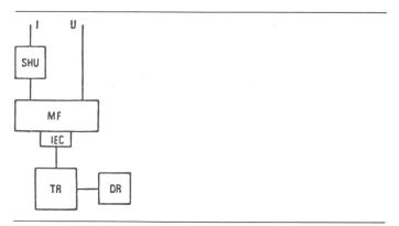
Fig. 5 Einphasige Leistungsmessung für Mischgrössen U und I mit Hilfe eines Strommesswiderstandes (SHU)
