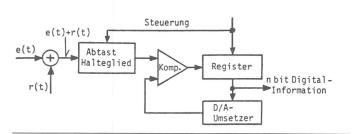
Fig. 10 Blockschaltbild einer AD-Konversion unter Verwendung des Prinzips der sukzessiven Approximation mit stochastischer Interpolation
