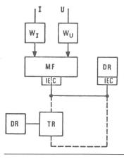
Fig. 2 Einphasige Leistungsmessung von Wechselgrössen U und I
