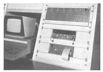
Fig. 9 Beispiel eines kundenspezifischen Leistungsmeßsystems mit Multifunctionmeter, Scanner, Drucker und Controller
