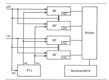
Fig. 7 Einphasige Messung von Grund- und Oberwellenleistungen allgemein periodischer Wechselgrössen mit Hilfe einer PLL-Schaltung (phase-locked loop) zur Erzeugung synthetisierter und synchronisierter sinusförmiger Referenzsignale
