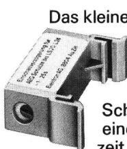
Das kleine AEG Minischütz hat grosses Format: Denn jetzt gibt es dazu eine elektronische Einschaltverzögerung. Klar, dass dieses Zusatzbauteil eine Schnappbefestigung und eine einstellbare Verzögerungszeit von 1 bis 20 Sekunden hat.
