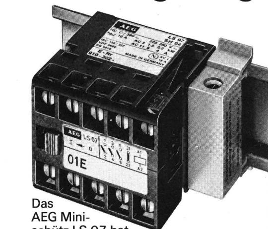
Das AEG Minischütz LS 07 hat ein Format, das genau unter die Blindabdeckung im Verteilerkasten passt. Im AC 1-Betrieb schaltet es 16 A und im AC 3-Betrieb 2,2 kW bei 380 V~. Das LS 07 gibt es mit Schraub-, Flachsteck- und Stiftanschlüssen, mit Gleich- und Wechselstromspule – und serienmäßig mit Schraub- und Schnappbefestigung.
