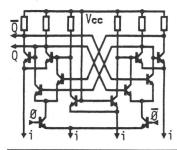
Fig. 2 ECL-Teilerstufe ECL = Emitter coupled logic
