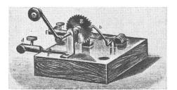
Fig. 4 Zahnradunterbrecher für Induktionsapparate [2]
