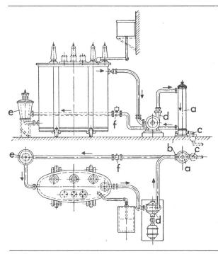
Fig. 15 Schema einer Ölumlauf-Kühlanlage mit Wasserkühlung [11]
