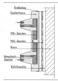
Fig. 17 Schnitt durch die Wicklungen eines Giessharztransformators (Moser-Glaser & Co. AG)
