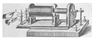
Fig. 1 Induktionsapparat, Ausführung als «Schlittenapparat» [1]
