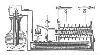
Fig. 3 Funkeninduktor mit Quecksilberunterbrecher und Kondensator K [2]
