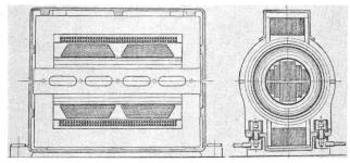
Fig. 12 Einphasen-Lufttransformator für 20 kV/220 V mit horizontalem Mantelkern, der auf angenäherte Kreisform gestuft ist
