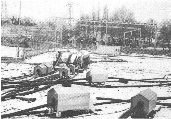
Fig. 3 Langzeitprüfungen in Verbois; Stromtransformatoren zum Heizen der Prüfkabel
