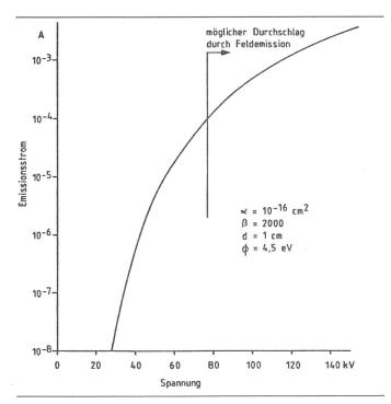
Fig. 1 Stromspannungscharakteristik einer Vakuumisolierstrecke unter für Vakuumschalter typischen Bedingungen
