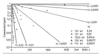
Fig. 3 Summenhäufigkeit für «kein Durchschlag bis zur Zeit T» in Abhängigkeit von der Dauer der Wechselspannungsbeanspruchung für verschiedene Spannungen
