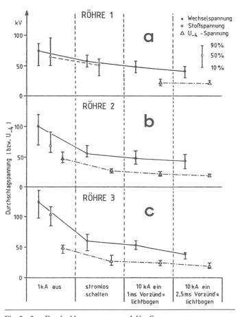
Fig. 2a–2c Durchschlagspannungen und  $U_{-4}$ -Spannungen von verschiedenen Vakuumschaltröhren nach Ausschaltlichtbögen, stromlosem Schalten und Einschalten verschiedener Ströme, gefolgt von stromlosem Öffnen (Scheitelwerte) Cu/Bi-Kontakte, Kontaktdistanz 10 mm
