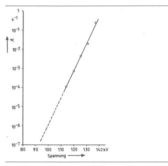
Fig. 4 Durchschlagswahrscheinlichkeitsdichte α in Abhängigkeit von der Spannung, Auswertung von Fig. 3
