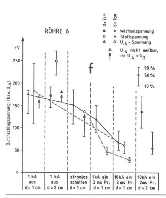
Fig. 2f Wie Fig. 2e, jedoch Kontaktdistanz 10 mm bzw. 20 mm
