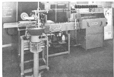
Tauchlöten der Spulenanschlüsse, Zugentlasten der Wicklung durch Nachdrücken der Stifte, elektrische Prüfung der Spule, geordnete Abgabe der Spulen in Paletten zu je 280 Stück. Die Steuerung der gesamten Anlage erfolgt über einen zentralen Mikrocomputer.
