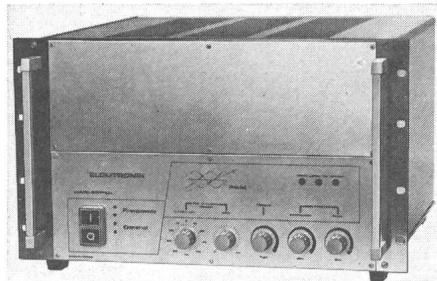
schaltungen existieren ferner eine Signalanpassung, eine Steuerung auf konstante Schnittgeschwindigkeit, eine Frequenz-(Drehzahl-)Anzeige mit Zeigerinstrument sowie eine Bremseinheit für hochdynamische Anwendungen.
