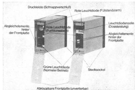
unabgeschirmte Leitungen. Ferner können die Geräte unterscheiden und auch anzeigen, ob ein Füllstand über- bzw. unterschritten ist oder ob eine Störung vorliegt. Sie bieten damit eine Sicherheit gegen Verfälschung des Messergebnisses durch Funktionsfehler.
