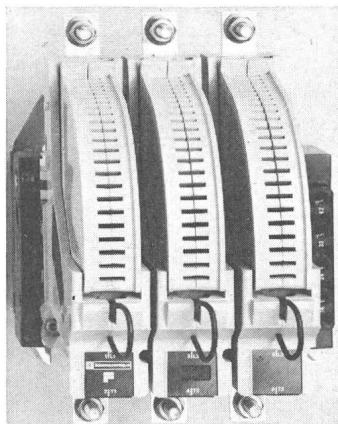
Kondensatorbatterien und Gleichstromkreisen. Es gibt drei Schütztypen von 400 A bis 850 A Nennstrom bzw. 4800 A bis 7000 A Einschaltstrom. Die Ausführung erfolgt in 2, 3 und 4 Polen mit Gleichstromantrieb durch eingebaute Gleichrichter. Die Schütze haben ferner eine Schaltstückabbrand-Anzeige, eine geringe Halteleistungsaufnahme sowie eine Schaltstellungsanzeige, einheitliche Hilfsschalterblöcke, einen mechanischen Verriegelungsbaukasten und ein Motorschutzrelais.
