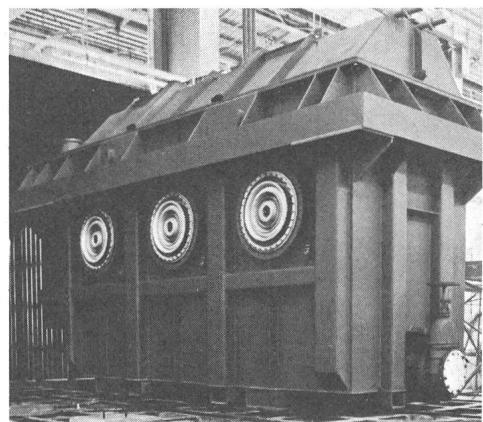
**WEIDMANN-Isolationssysteme aus TRANSFORMERBOARD sind TE-frei bis zur Prüfspannung.**
