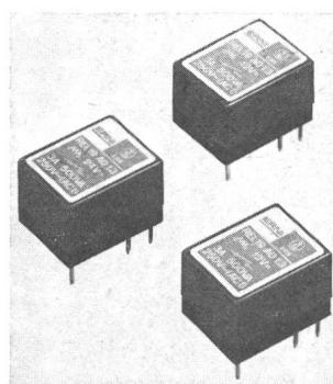
ausgerüstet und für Schaltspannung 250 V AC/30 V DC, Schaltstrom 3 A, Schalteistung 500 VA/60 W sowie Spulenspannung 6, 9, 12, 24 V DC geeignet. Die Anschlüsse liegen im  $1/10$ -Rastermass. Weitere Merkmale: hohe Lebensdauer ( $2 \times 10^7$  mechanisch); lötbadbeständig. Anwendungsgebiete sind die industrielle Elektronik, Maschinensteuerungen, Alarmgeräte usw.
