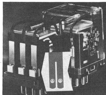
nische Lebensdauer > 150 Mio Schaltungen, in der Relaishaube integrierte Handbetätigung, Kontaktenschaltleistung 220 V/10 A, 380 V/4 A, AC, behalten auch für diese neuen Ausführungen ihre Gültigkeit.
