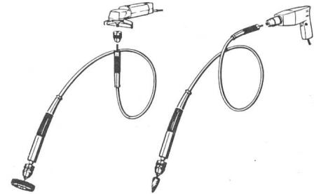
bereits einen kleinen Werkzeugsatz. Der Anschluss der biegsamen Welle an den Einhandwinkelschleifer ist ebenso einfach wie an eine Handbohrmaschine. Es wird lediglich empfohlen, die Maschine bei der Arbeit leicht zu fixieren.
