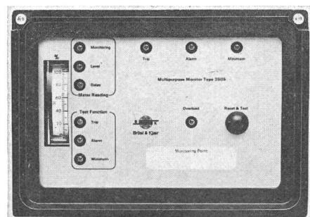
stellen weiterleiten und notfalls die überwachte Anlage beim Erreichen kritischer Schwingungspegel selbsttätig abschalten. Ein automatischer Testzyklus überprüft die voreingestellten Referenzwerte und testet gleichzeitig die Signalleitungen. Ein Gleichspannungsausgang ermöglicht Fernablesung und -aufzeichnung. So kann der Monitor als Teil des gesamten Überwachungssystems «on line» mit einem Computer verbunden werden.
