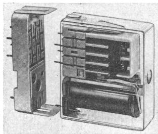
anlagen, Stanzpressen, Montageautomaten, Eisenbahnsicherungsanlagen sind deshalb sich selbst überwachende, absolut sichere Schaltungen vorgeschrieben oder empfohlen. Haller-Sicherheitsrelais H-462 erlauben, einfache und gefahrlose Schaltungen aufzubauen. Ihre Nenndaten sind 380/220 V, 50 Hz bzw. 440 V~ sowie 10 A bzw. 5 A. (Lechmann + Müh AG, 3073 Gümligen)
