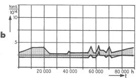
Fig. 6 Lebensdaueruntersuchungen an zehn 5-μF-MKV-Kondensatoren Versuchsbedingungen 500 V, 50 Hz, +70 C
