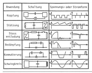
Fig. 1 Kondensatoren der Energieelektronik: Anwendungsübersicht
