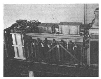
Gleichstromzwischenkreis für Drehstrom-Wechselrichter der Lokomotive Am 6/6 der SBB Sichtbar: Gleichspannungskondensatoren 1200 μF/1600 V-; nicht sichtbar rechts im Öltank: Kommutierungskondensatoren 59 μF/2100 V~
