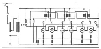
Fig. 7 Prinzipschaltbild der Rekuperationsbremse bei der Re 6/6
