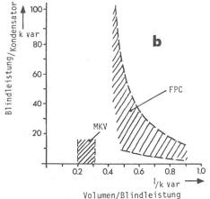
Fig. 3 Vergleich von Kondensatoren mit Folienbelägen (FPC) und metallisierten Belägen (MKV)
