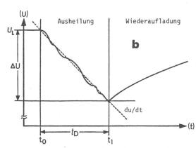
Fig. 5 Zeitlicher Verlauf eines Selbstheilvorganges
